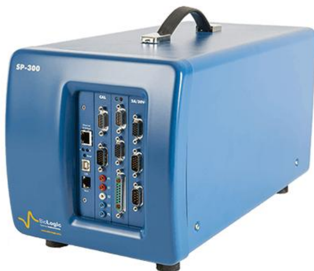
Figure II.12: Photographie du potentiostat utilisé pour les expériences.
