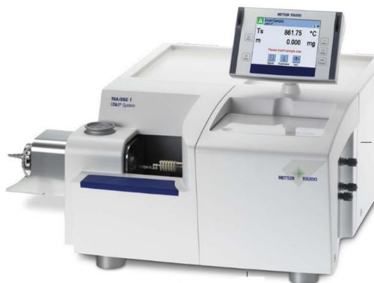
Figure II.9: Photographie de l'Analyseurs thermogravimétriques (ATG).
