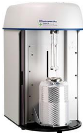
Figure II.7: Photographie de l'Analyseur de surface Micromeritics Tristar II 3020.
