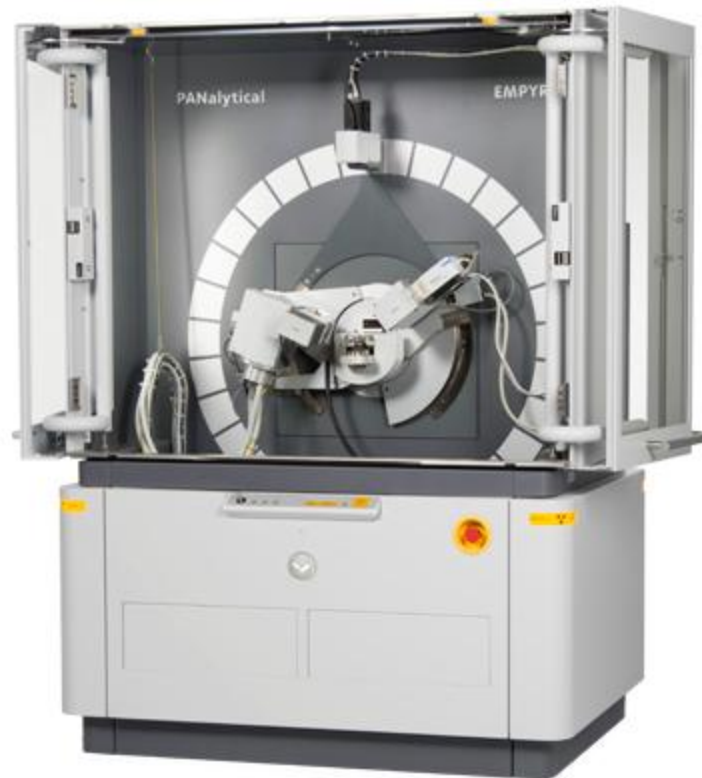
Figure II.4: Photographie du diffractomètre utilisé.
