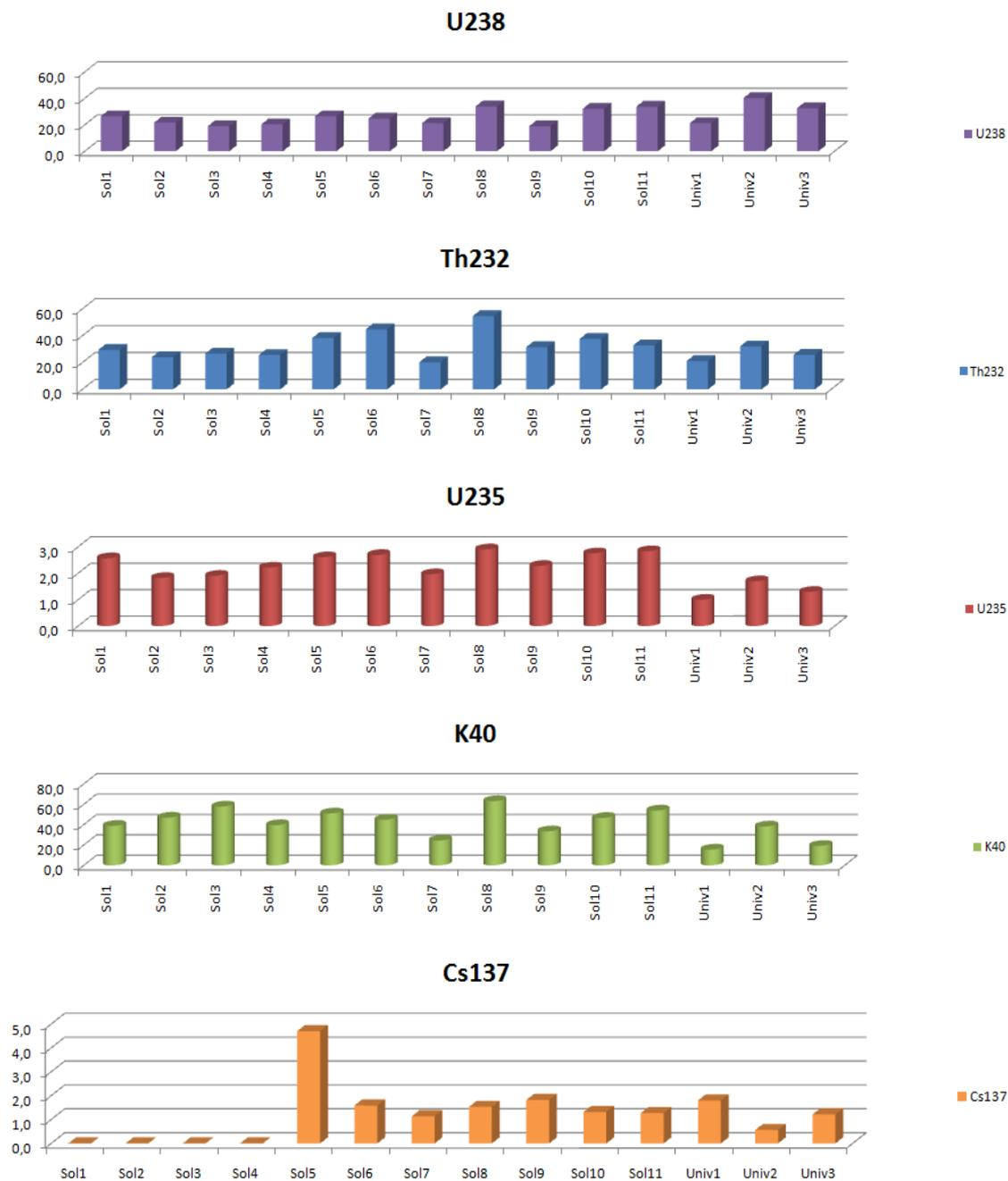
FIG. 6.16 – Histogrammes des activités spécifiques moyennes du  $^{232}\text{Th}$ ,  $^{235}\text{U}$ ,  $^{238}\text{U}$ ,  $^{40}\text{K}$  et  $^{137}\text{Cs}$  dans les échantillons des sols.
