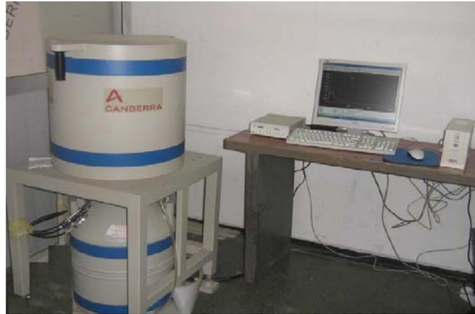
FIG. 6.11 – Chaîne de spectrométrie gamma du CRNA
