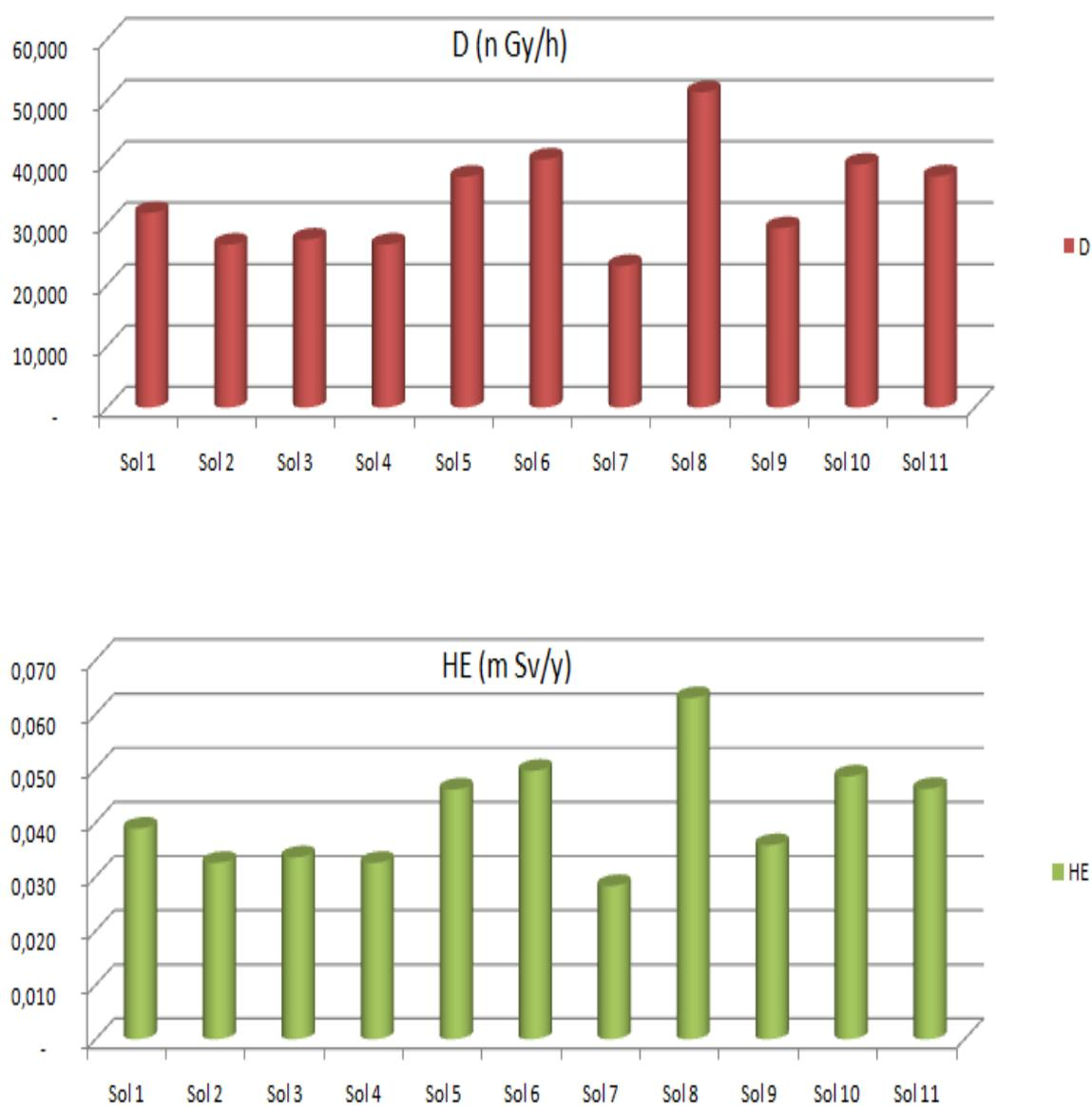
FIG. 6.20 – Histogrammes des débits de dose absorbée et efficace des échantillons du sol analysés au CRNA
