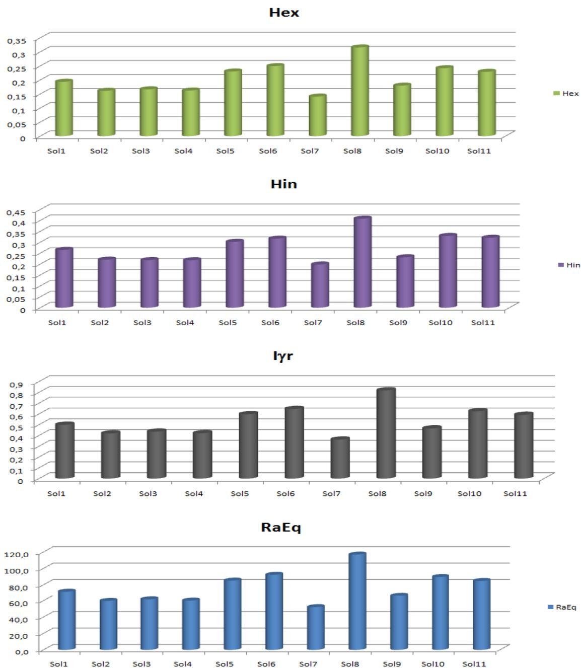
FIG. 6.18 – Histogrammes des indices de risque  $H_{ex}$ ,  $H_{in}$ ,  $I_{\gamma r}$  et  $Ra_{eq}$  des échantillons du sol analysés au CRNA
