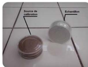
FIG. 6.6 – Source de calibration et échantillons dans leurs conteneurs
