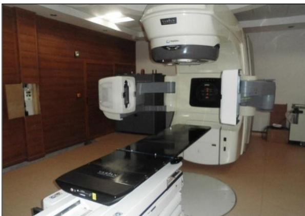
Figure III.7 Système d'imagerie embarqué. Centre Anti-Cancer ATHENA.
