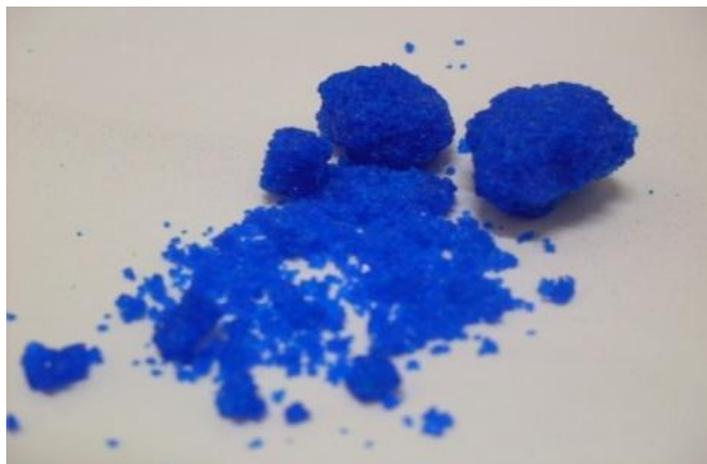
**Figure II.12:** Le précurseur utilisé  $\text{Cu}(\text{NO}_3)_2 \cdot 3\text{H}_2\text{O}$  (Pureté 97%, masse molaire 290,81 g/mol).
