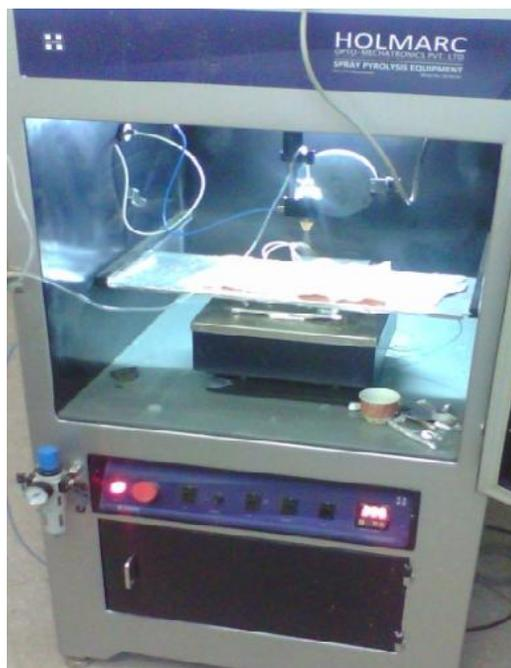
**Figure II.13:** L'appareil spray pyrolyse utilisé
