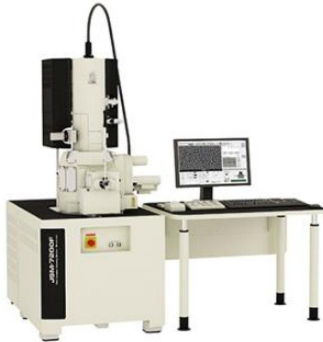
**Figure-II-10-** l'appareil de microscopie électronique à balayage (MEB) JEOL JSM - 7200[71].
