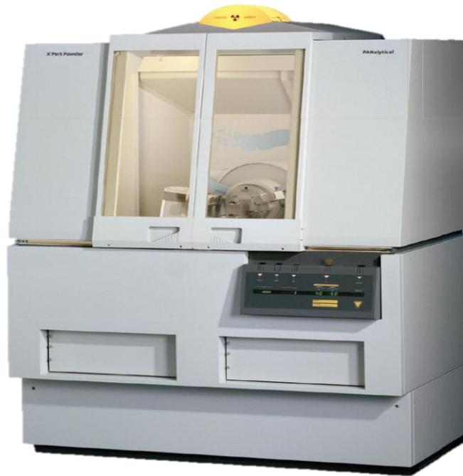
**Figure-II-9-** l'appareil de Diffraction des rayons X Expert Powder Panalytical PW3040/60[69].
