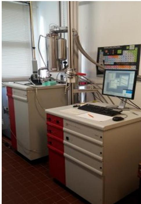
**Figure-II-18**-Magnétomètre à SQUID (MPMS) [56].
