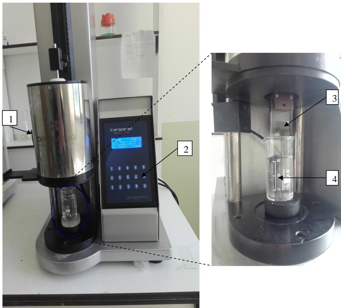
**Figure 3.6:** Dispositif expérimental "dip-coater" utilisé pour l'élaboration des films TiO<sub>2</sub> avec : (1) chambre de séchage, (2) unité de commande, (3) substrat, (4) solution
