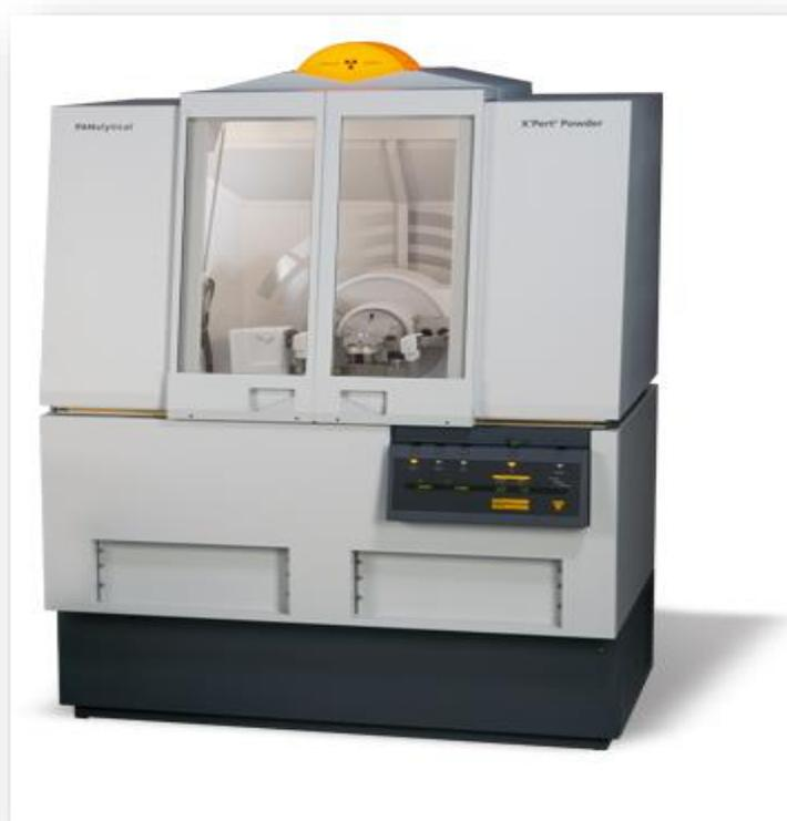
**Figure IV.2.3 :** Le diffractomètre de type Philips X Pert pro
