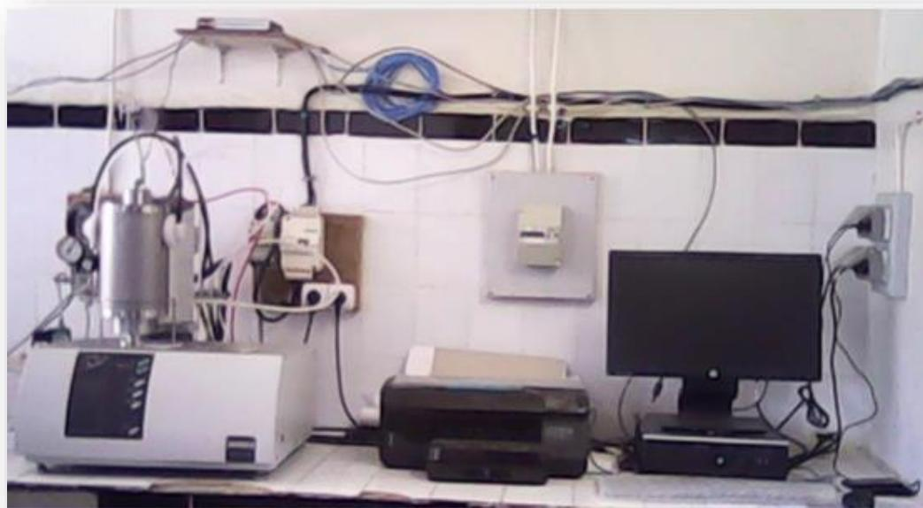
**Figure IV.2.2 :** L'appareil de DSC de type Jupiter Netzsch STA 449 F3.
