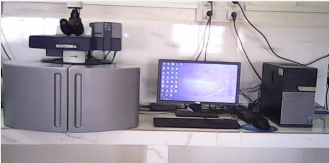
**Figure IV.2.7.b** : Le spectromètre RAMAN Bruker Senterra.
