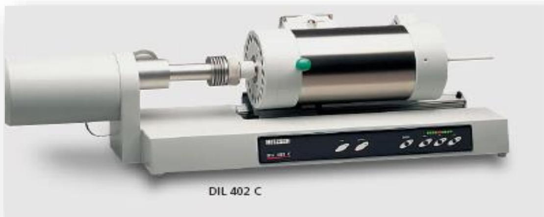
**Figure IV.2.4:** Dilatomètre de type DIL 402C NETZSCH4
