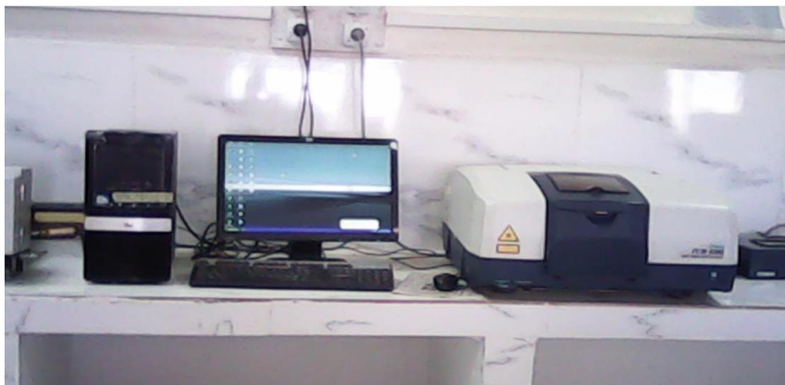
Figure IV.2.8.d: Spectromètre infrarouge Jasco FTIR /IR-6300.
