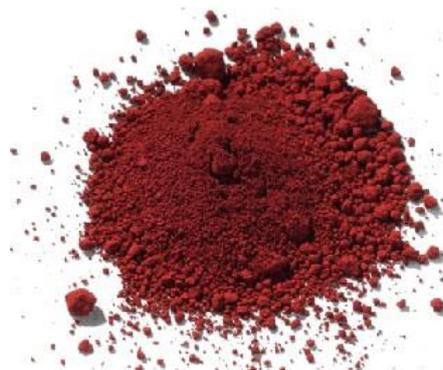
**Figure I. 11.** Poudre de  $\text{Cu}_2\text{O}$ .
