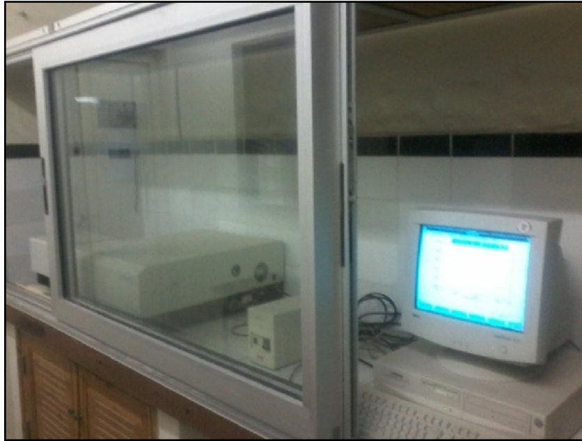
Figure II.15 : Photographie du spectrophotomètre UV-Visible Shimadzu type UV3101 PC, de l'Université des Frères Mentouri-Constantine 1
