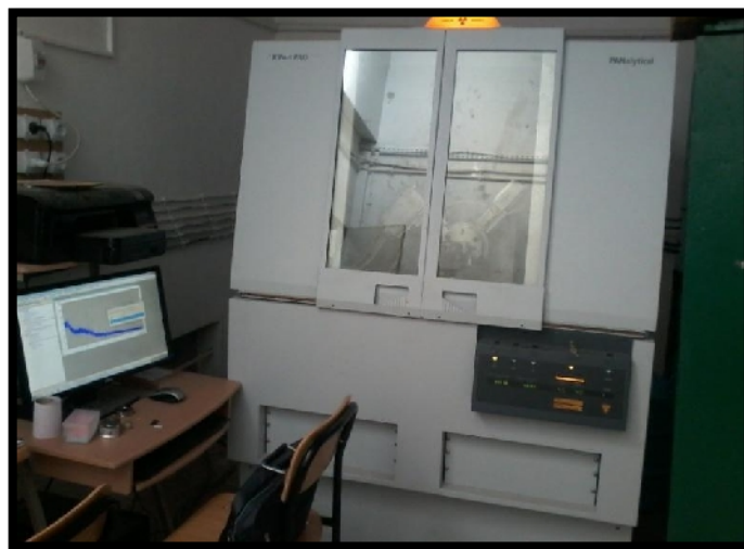
Figure II.11 : Photographie du diffractomètre Panalytical X'PERT PRO de Université des Frères Mentouri Constantine 1, Algerie).
