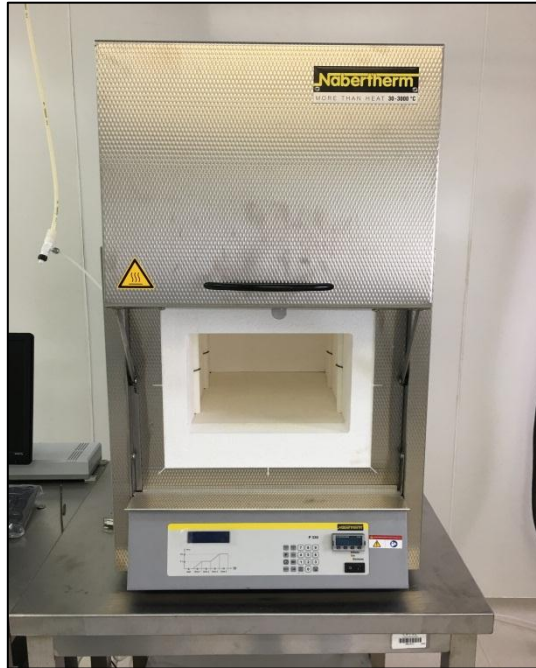
Figure II.1 : Four à moufle utilisé pour les traitements d'oxydation.
