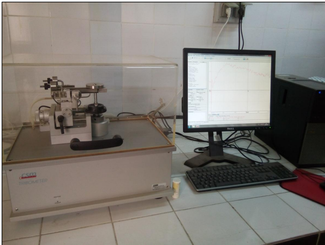
Figure II.13 : Tribomètre bille sur disque de type CSM.
