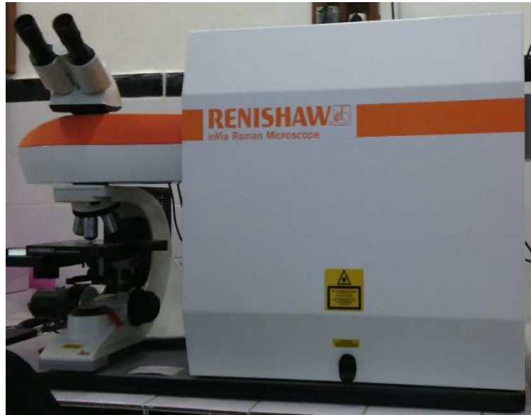
Figure III.9: Dispositif expérimental de mesure spectroscopie Raman.
