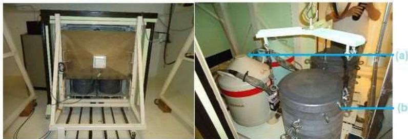
FIGURE 3.7 – (a) cryostat d'azote liquide (b) cylindres de plomb d'épaisseur 10 cm.
