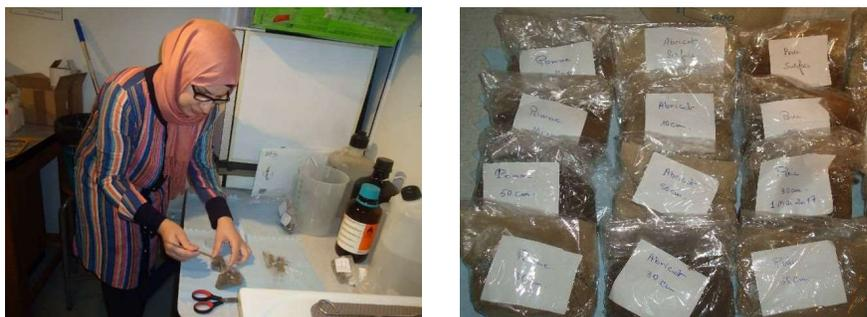
FIGURE 3.3 – LBA/LPSC Laboratoire de mesure par spectrométrie gamma et des échantillons de sol préparé scellé avec du ruban en plastique pour empêcher la contamination des détecteurs.
