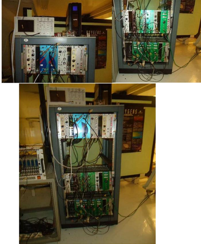
FIGURE 3.10 – *L'instrumentation électronique utilisée dans l'étude actuelle, montrant l'amplificateur de mise en forme et l'alimentation haute tension.*
