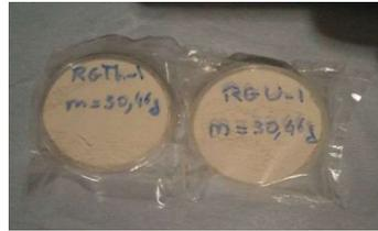
FIGURE 3.15 – Échantillons de référence de Thorium et d'Uranium *RGU-1* et *RGTh-1*, fournis par l'AIEA.
