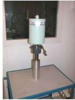
FIGURE 2.15 – détecteurs coaxial de longueur 50 mm et de 50 mm de diamètre.
