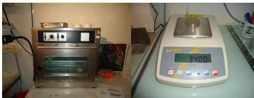
FIGURE 3.4 – Séchage et pesage des échantillons.
