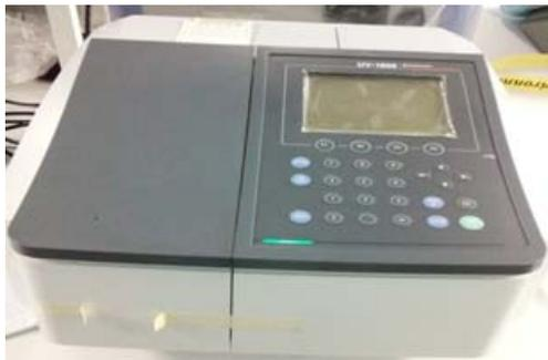
**Figure II.22:** Spectrophotomètre UV-visible
