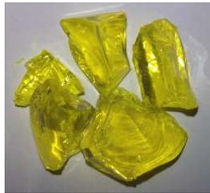
Figure III.2. Charge (Craquelé) utilisée pour le tirage du YAG-Ce par  $\mu$ -PD.
