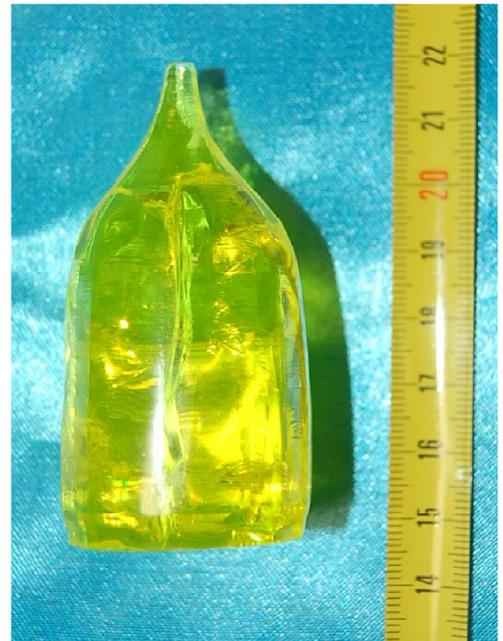
Figure II.2. Principe de la méthode de tirage Czochralski (à gauche), un cristal de YAG:Ce (à droite).
