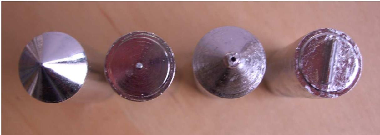
Figure III.8. Les différents formes des creusets utilisés dans la technique  $\mu$ -PD.
