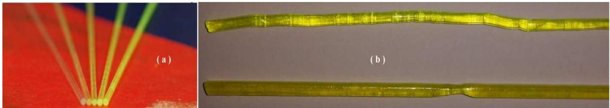
Figure III.13. Fibres YAG-Ce – (a) fibres sans défauts apparents – (b) fibres avec des défauts
