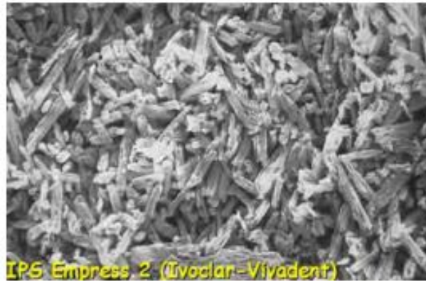
Figure I.6. Microphotographie en MEB d'un échantillon de vitrocéramique Empress 2 [6].
