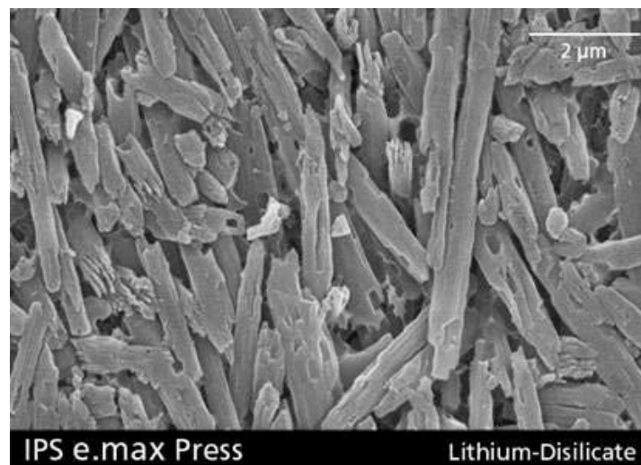
Figure II.3. Microstructure de l'IPS e.max Press (en microscopie électronique à balayage) [57].
