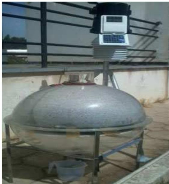
Figure IV.1 Distillateur sphérique et station météorologique sans fil
