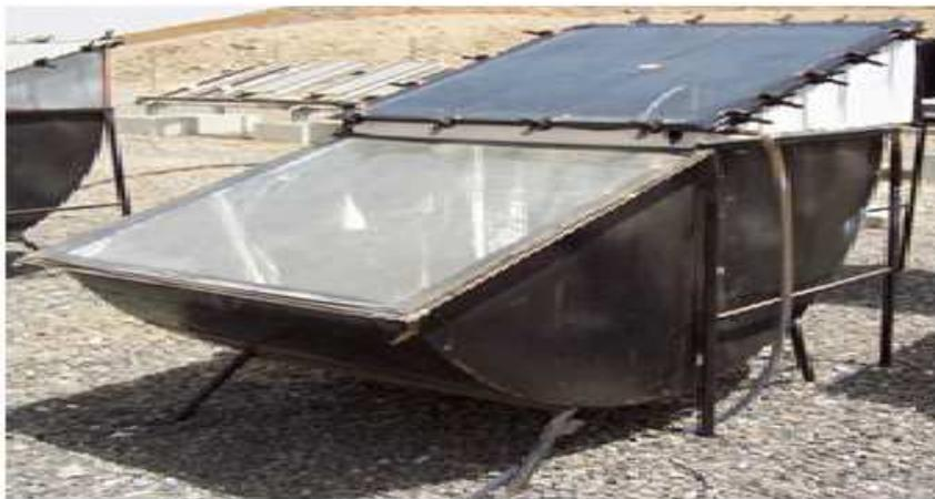
Figure I.13 Distillateur solaire à bassin inversé
