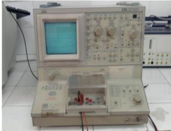
**Figure III.9:** Le dispositif de la caractérisation I(V) pour le test des hétérojonctions CZTS/CdS, ZnS (Labo. LCMI, Univ. Constantine 1).
