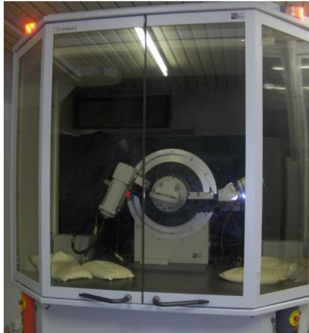
Fig.II.16 Diffractomètre utilisé pour les caractérisations structurales (BRUKER-AXS- D8).
