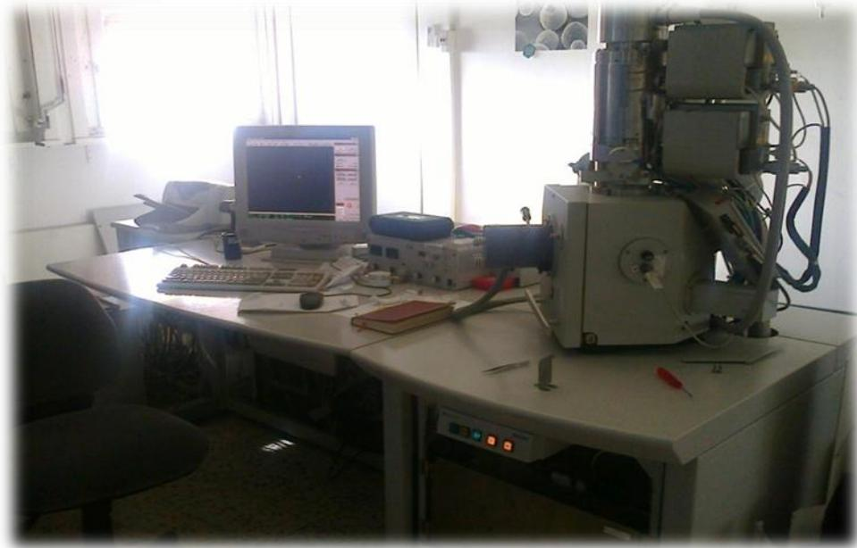
*Figure II.14. Microscopie électronique à balayage de type ESEM XL 30 FEG Philips de CRNA.*
