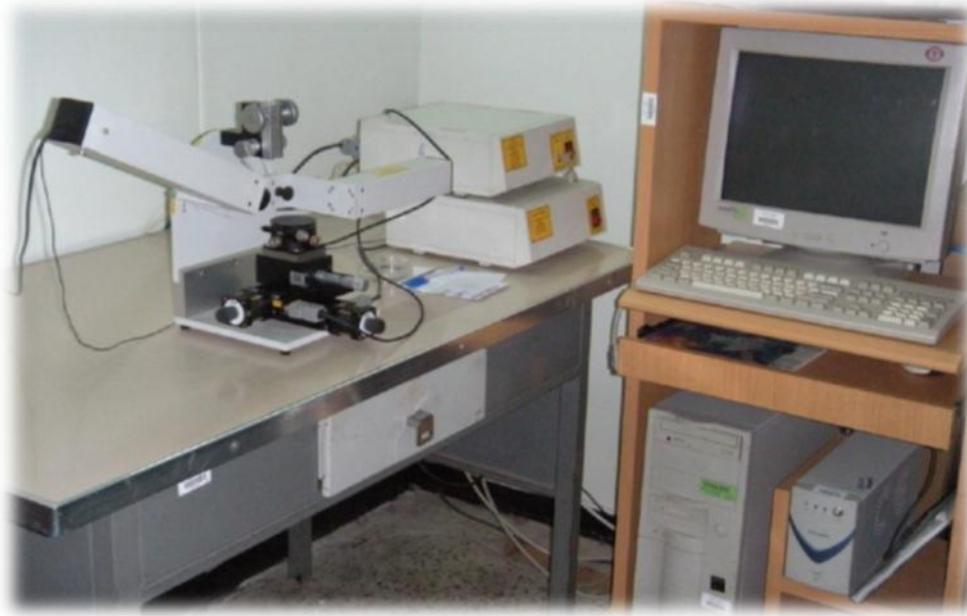
*Figure II.19. Ellipsomètre utilisé pour la caractérisation des échantillons de CRTSE.*
