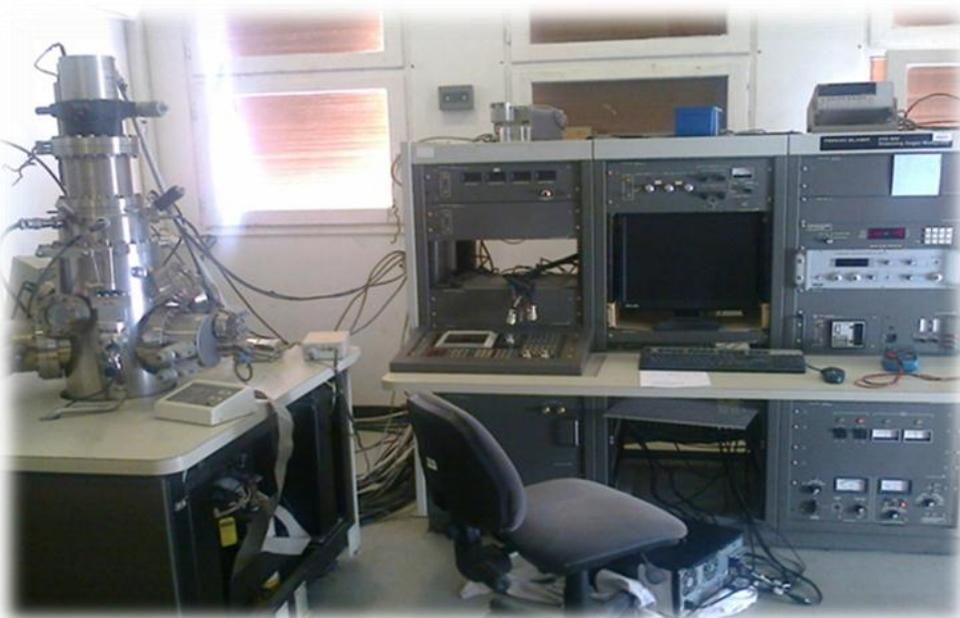
**Figure II.24.** Spectroscopie Auger Perkin Elmer avec une sonde PHI 600 de CRNA.
