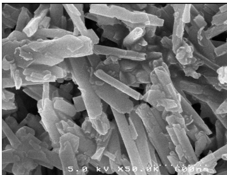
الشكل 3.ii. صورة بالمجهر الالكتروني لحبيبات المادة الخام للكاولان KDD2 .
