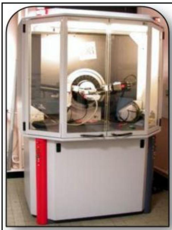
**Figure II-11 : Photographie du diffractomètre Bruker D8 Advance (Unité de recherche, Université Mentouri, Constantine, Algérie).**
