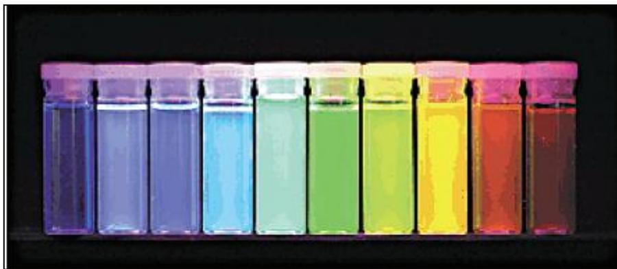
**Figure I-6 : Dix couleurs distinguées d'émission des points quantiques de CdSe/ZnS excités par une lampe proche-UV [65]**
