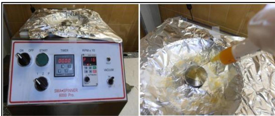
Figure II-10 : Dispositif utilisé pour effectuer les dépôts.
