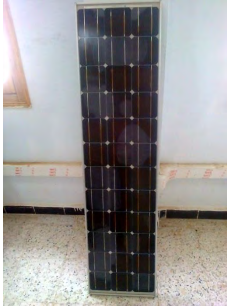
Figure 1.15. Exemple de délamination dans un module photovoltaïque du type UDTS-50.
