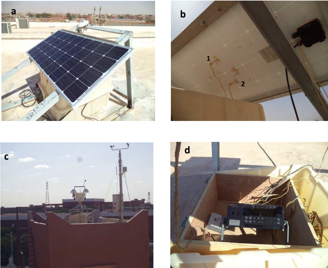
Figure 3. 1. La chaîne expérimentale: a) Module photovoltaïque monocristallin placé sur le toit de l'URER/MS; b) Les deux thermocouples du type K placé a l'arrière le module ; c) La station météorologique de NEAL ; d) L'acquisition de données (Fluck Hydra 2635A).
