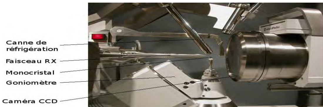
Figure I-1: Monocristal monté sur le diffractomètre quatre cercles XCalibur (laboratoire de cristallographie d'université de Constantine 1)
