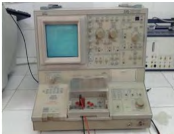
Figure II.26. Le dispositif de la caractérisation I-V pour le test de la cellule PbS/CdS/FTO (Labo. LCMI, Univ. Constantine 1).
