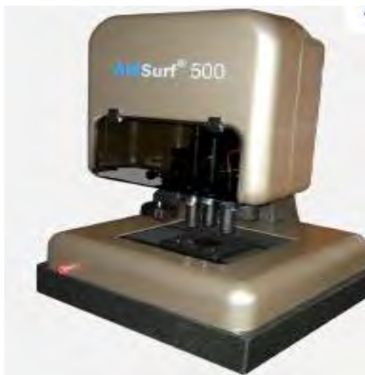
Figure II.2. Profilomètre Altisurf 500 utilisé pour la mesure des épaisseurs de nos films.
