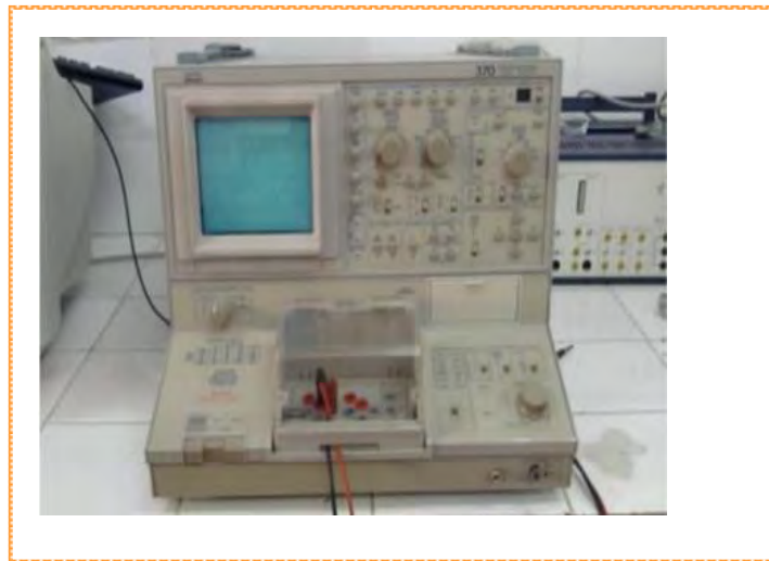
Fig.II.16: Le dispositif de la caractérisation I-V pour le test de la cellule SnS/CdS, ZnS (Labo. LCMI, Univ. Constantine).
