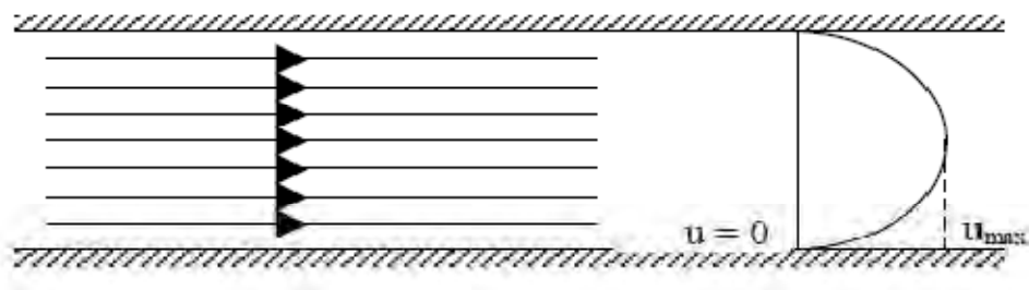
Figure (1.20) : Schématisation d'un écoulement laminaire.
