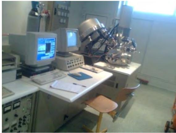
*Fig. III.19.b : Vue du microscope Auger de type « Microlab 310D » (Institut Jean Lamour, Univ. de Lorraine, Nancy - France)*
