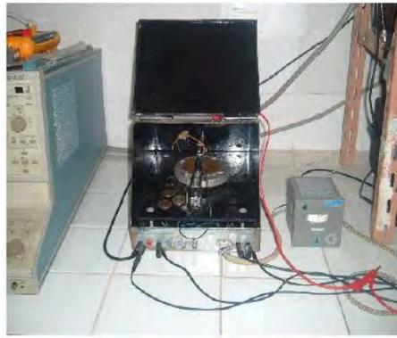
Fig.III.20.a : Système des deux pointes, réalisé au LCMI (Univ. Constantine 1).
