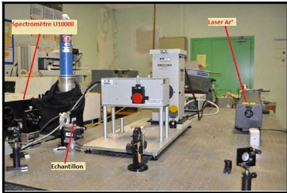
Figure 13 : Montage de spectroscopie de Luminescence Spectromètre Jobin-Yvon U-1000 double réseaux pour les mesures de la photoluminescence
