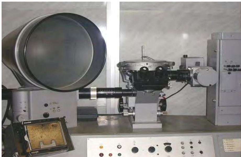
Fig. IV-8 : Le microscope optique de type LEITZ MM6.
