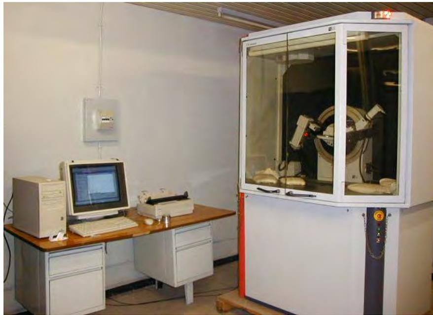
Fig. IV-4 : Le diffractomètre utilisé de type Siemens D8 Advance connecté à un microordinateur.
