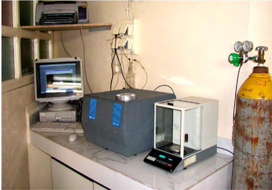
Fig. IV-1: L'analyseur de type SETARAM DSC 131 connecté à un microordinateur.
