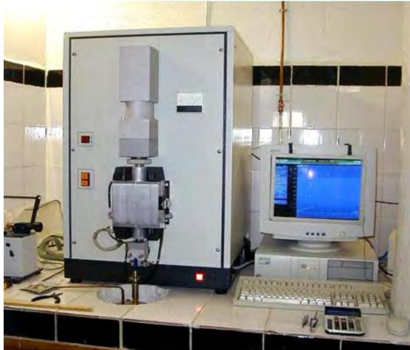
Fig. IV-2 : Le dilatomètre utilisé ADAMEL LHOMERGY de type DT1000 connecté à un microordinateur.
