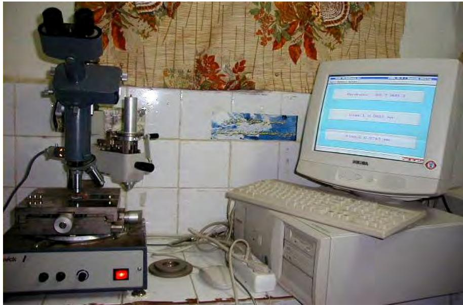
Fig. IV-6 : Le microduromètre utilisé de Type ZWICK relié à un microordinateur.
