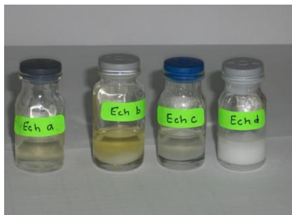
Figure II.10 Effet du rapport de concentrations des précurseurs chimiques sur la couleur et la précipitation du gel : a : 0.06, b : 0.25, c : 0.5 et d : 1
