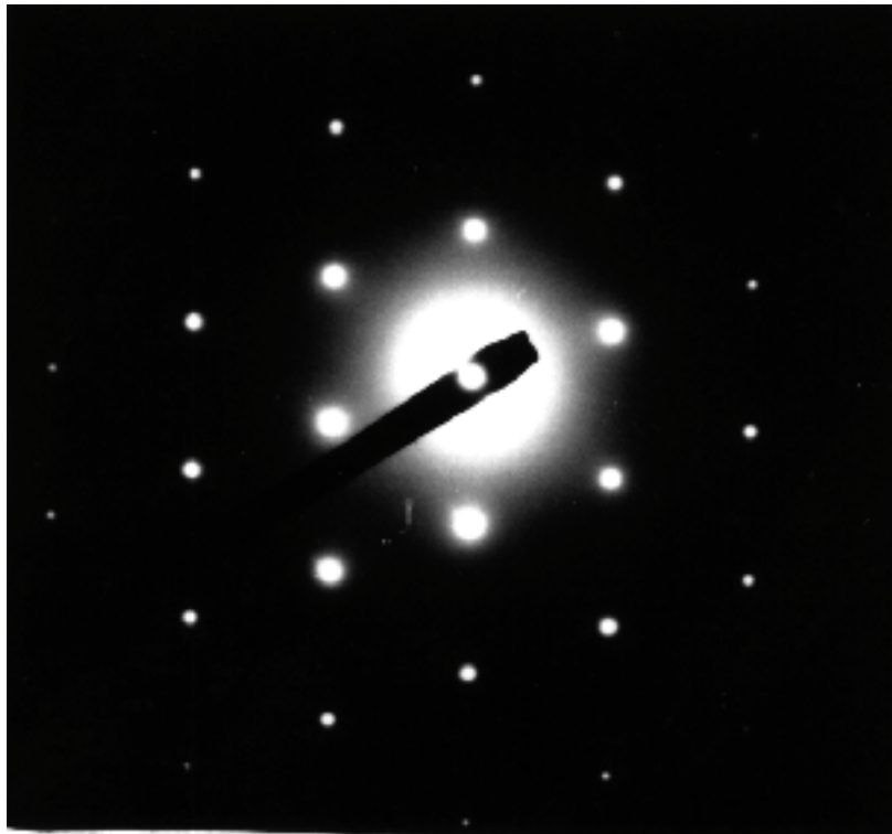
Fig.IV.18 : Diagramme de diffraction électronique d'un échantillon de silicium implanté 10^{16}\text{C}^+/\text{cm}^2 et irradié par trois impulsions laser successives d'énergie de 1\text{J}/\text{cm}^2 montrant la croissance épitaxiale.
