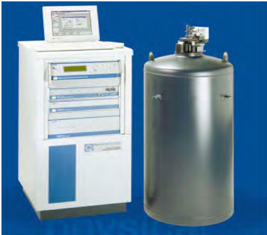
Figure II.10: Photographie du PPMS : à gauche centrale de mesure, de commande et d'alimentation de la bobine supraconductrice; à droite cryostat avec garde d'azote contenant la bobine supraconductrice pour la production du champ magnétique et l'anticryostat pour le contrôle de la température de l'échantillon.
