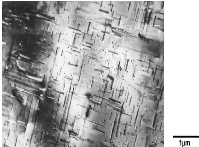
Figure II.8 : Microstructure TEM de l'alliage Al 1.2 % Mg 2 Si Homogénéisé à 560 °C, trempé à l'eau et vieilli 10 minutes à 200°C [70].
