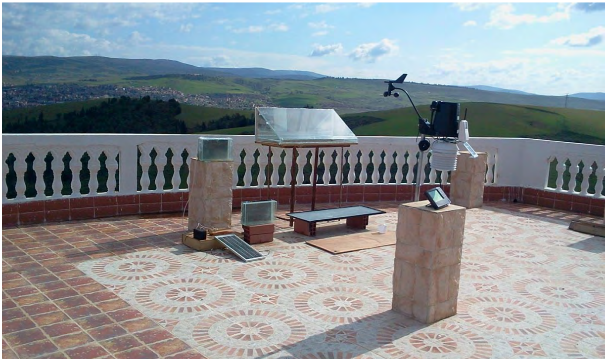
Fig. 69 Le distillateur solaire à canaux et la station météo sur le site des tests à Zouaghi Constantine
