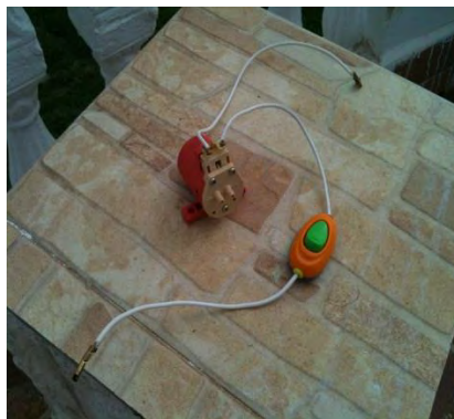
Fig. 63 La pompe avec un interrupteur
