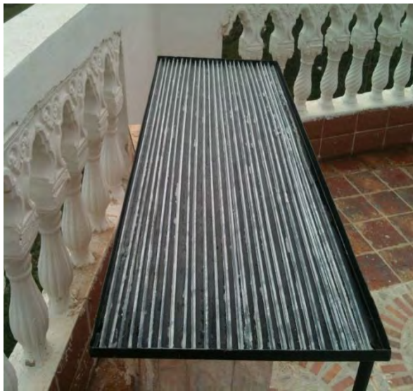
Figure 55 L'absorbeur avec des lamelles en plexi-glace
