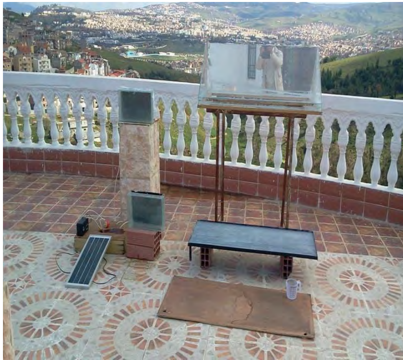
Figure 51 Les différents éléments composant le système de distillation
