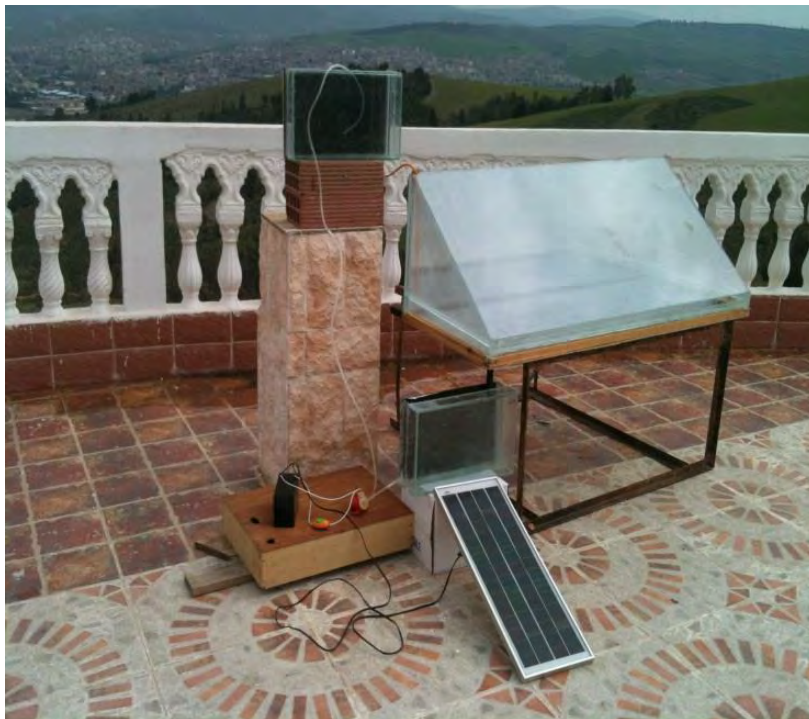
Figure 50 Système du distillateur solaire à canaux conçu
