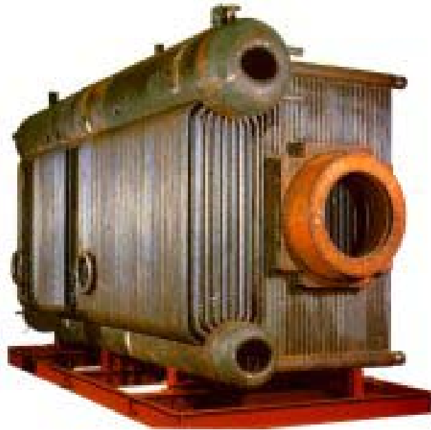
Figure I.8 : Générateur de vapeur à tubes d'eau typique.
