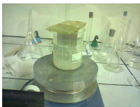
Figure (II.18): La solution, 7min après l'ajout du dernier réactifs (début de formation de PbS)
