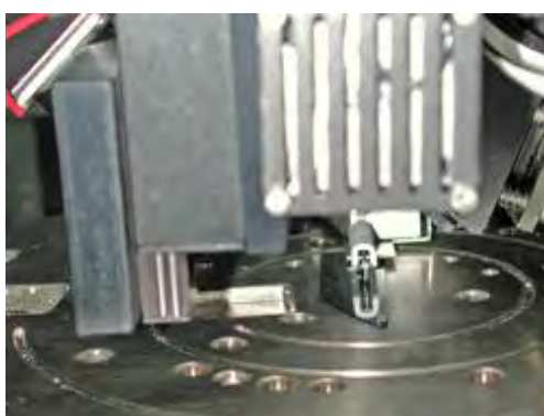
Figure (II.21): Schéma de la tête de mesure du Profil mètre utilisé pour la mesure d'épaisseur des films
