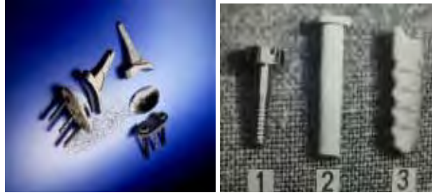
الشكل II-4 يمثل مجموعة من القطع البديلة المصنوعة من مواد خزفية خاملة.
