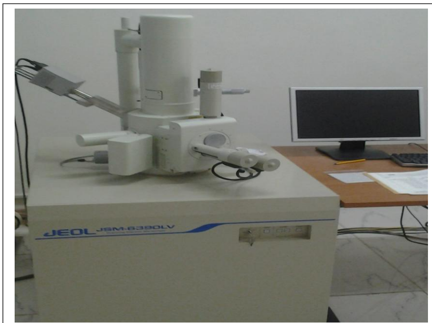
Figure III.30 : Photographie du microscope électronique à balayage (Laboratoire de DRX, Université Mohamed Khider, Biskra).
