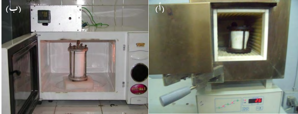
الشكل 3-II: يمثل طريقة المعالجة الحرارية المائية (أ) في الفرن العادي و (ب) في الفرن الميكروموجي
