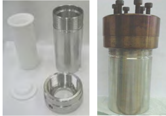
الشكل I-04: طريقة المعالجة الحرارية المائية [48].
