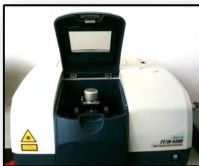
Figure IV-10 : Spectromètre à transformée de Fourier de type Jasco(FT/IR-6300) utilisé dans ce travail ( Laboratoire de Cristallographie, Université Constantine1, Algérie).
