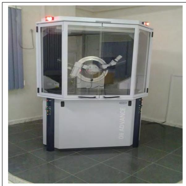
Figure III. 3: Photographie du diffractomètre Bruker D8 Advance (Laboratoire de DRX, Université Mohamed Khider, Biskra)
