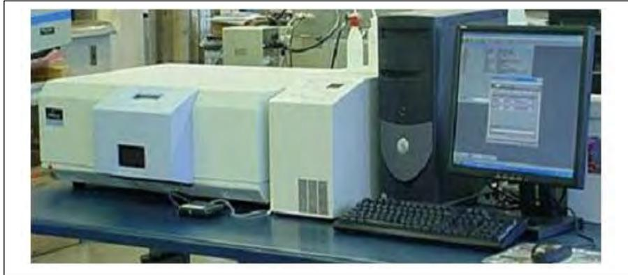
Figure IV.12 : Spectromètre de photoluminescence Perkin Elmer LS 55
