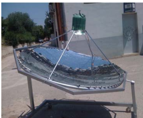
Figure 4.I.2 – Photographie de prototype et Coupe de réflecteur paraboloidal
