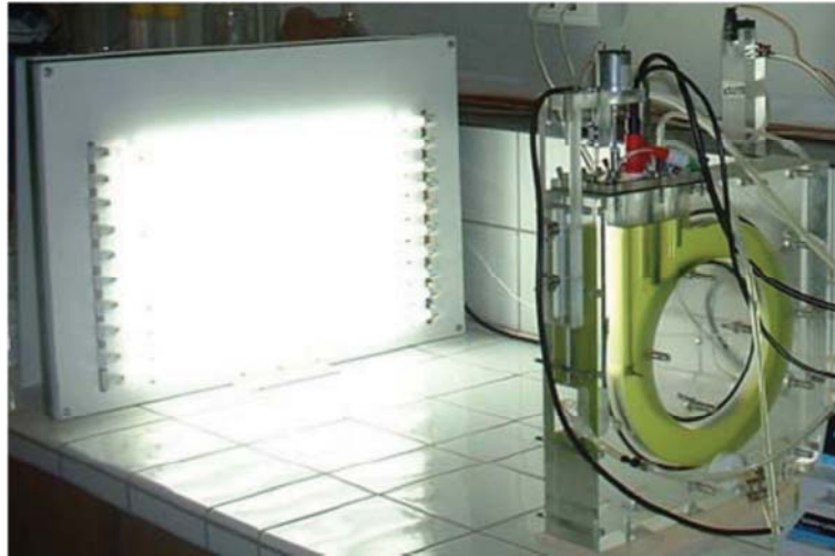
Figure 1.18 – Photobioréacteur d'étude pour la photobiologie d'hydrogène [32]
