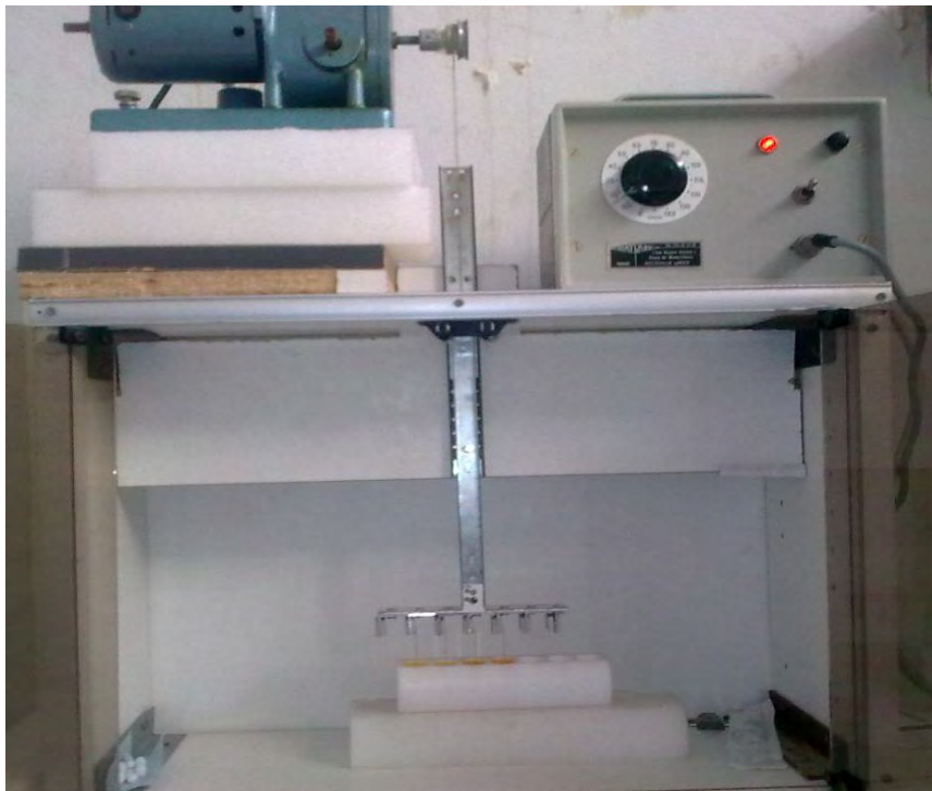
Figure II.1. Dispositif de dépôt des couches minces par dip-coating (conception et mise au point au laboratoire).
