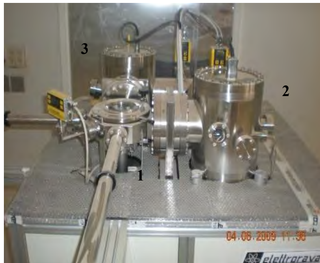
Figure III.3 : Unité de croissance : chambre de changement (1) chambre de dépôt par RF-PECVD (2) chambre de dépôt par HWCVD (3)
