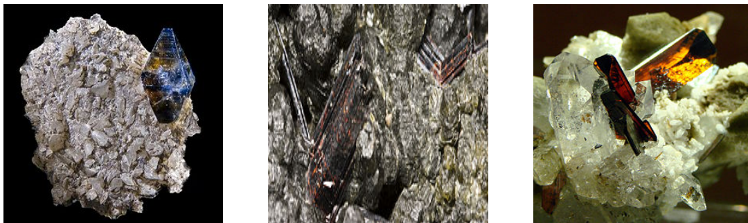
Figure I. 1: Espèces minérales formées d'oxyde de titane: (a) anatase; (b) rutile; (c) brookite. (Source:Wikipédia)
