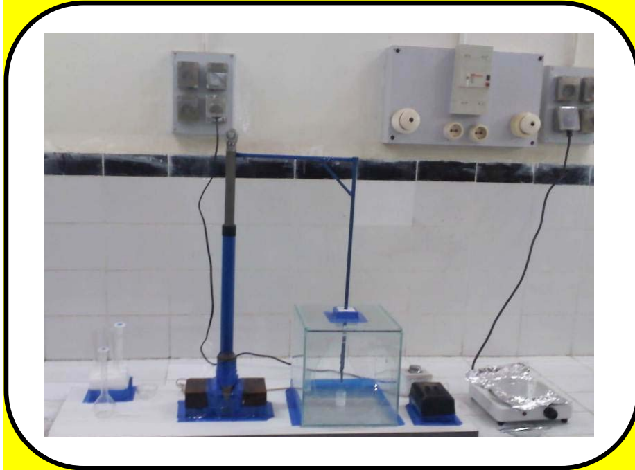
Figure III. 1: Dispositif expérimental de tirage des couches fabriqué au Laboratoire Couches Minces et Interfaces de l'Université Constantine 1.
