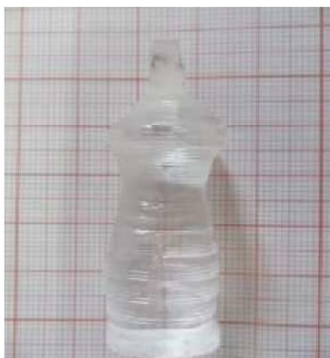
Fig. II. 4 ; Monocristal de KCl/CdSe
