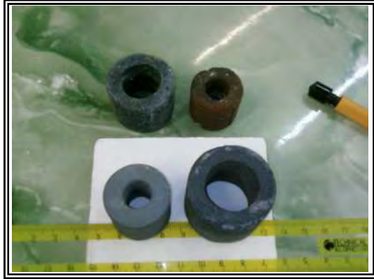
شكل III.2: صورة فوتوغرافية لعنصر التسخين المحسن (يمين) و مقارنة بينه و بين عنصر التسخين القديم (يسار).
