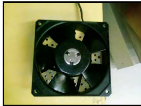
شكل 14.III : صورة فوتوغرافية لجهاز التبريد بعد تركيبه على الهيكل العلوي لفرن الميكرويف. يمكن ملاحظة شبكة الثقوب بين عنفات المروحة على اليمين وبراغي التثبيت على اليسار.
