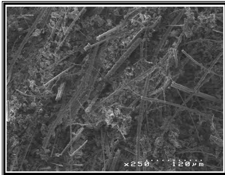
شكل III.11 : صورة بالمجهر الإلكتروني الماسح تظهر البنية المجهرية لمادة الألومينا الليفي التي استعملت في تصميم العازل الحراري.
