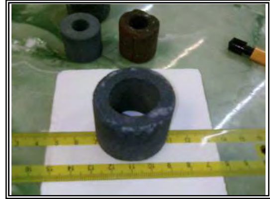
شكل III.2: صورة فوتوغرافية لعنصر التسخين المحسن (يمين) و مقارنة بينه و بين عنصر التسخين القديم (يسار).
