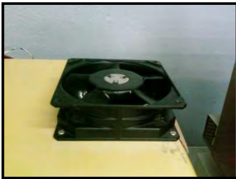
شكل 14.III : صورة فوتوغرافية لجهاز التبريد بعد تركيبه على الهيكل العلوي لفرن الميكرويف. يمكن ملاحظة شبكة الثقوب بين عنفات المروحة على اليمين وبراغي التثبيت على اليسار.
