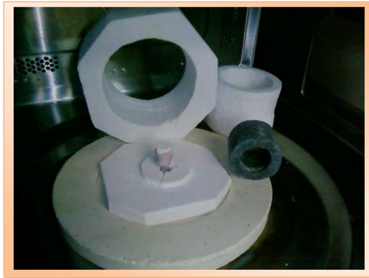
شكل 5.V: الأجزاء الأساسية لمنظومة التسخين بالميكرويف المستعملة في تليد عينات الـ HA في المركز.
