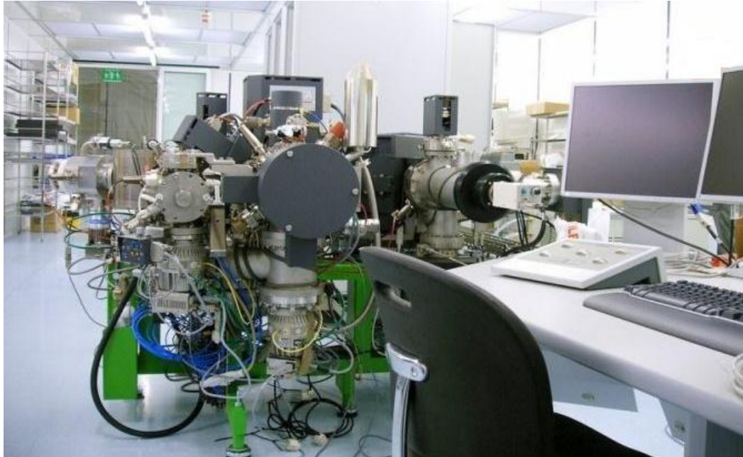
Figure 2-6 Instrument SIMS , de type IMS 7F, mis en œuvre pour l'analyse des échantillons.
