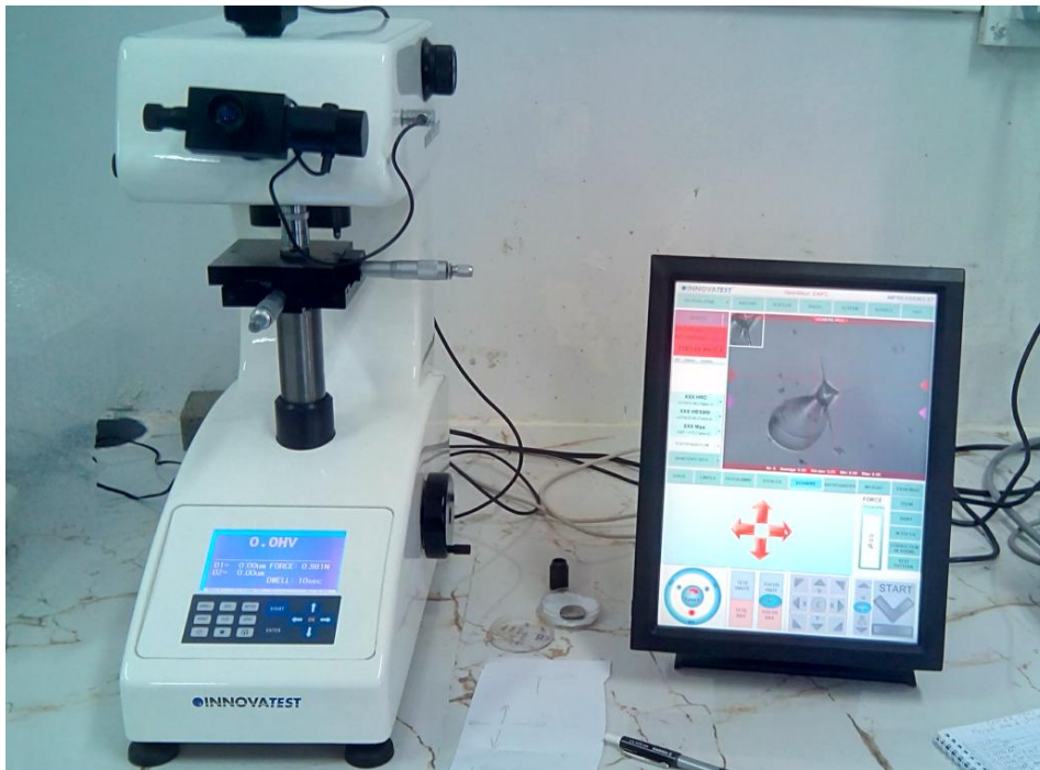
Figure 2-14 Photo du micro duromètre utilisé pour les mesures de duretés des échantillons.
