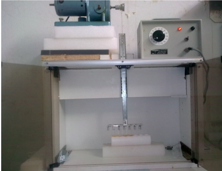
Figure III.5. Dispositif de dépôt des couches minces par dip-coating (conception et mise au point au laboratoire).
