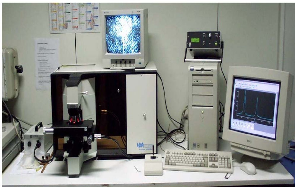
Figure III.11. Dispositif expérimental de la rétrodiffusion ( \mu -Raman).
