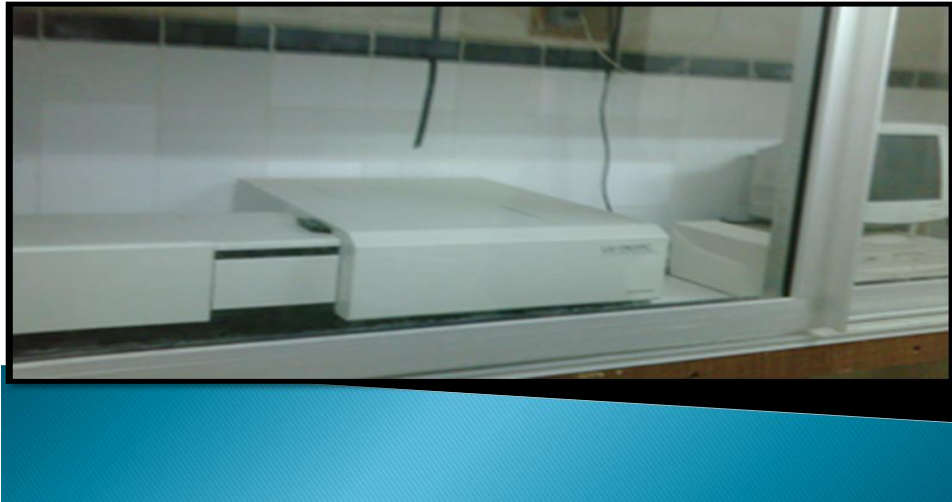
Figure II.9 : Photographie du spectrophotomètre UV-Visible utilisé dans ce travail (Unité de recherche, Université Mentouri, Constantine, Algerie)
