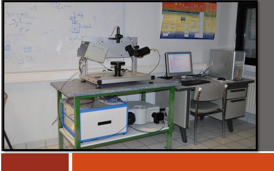
Figure II.10: Photographie de l'ellipsomètre utilisé pour la caractérisation de nos échantillons (Laboratoire LPhiA, université d'angers, France)
