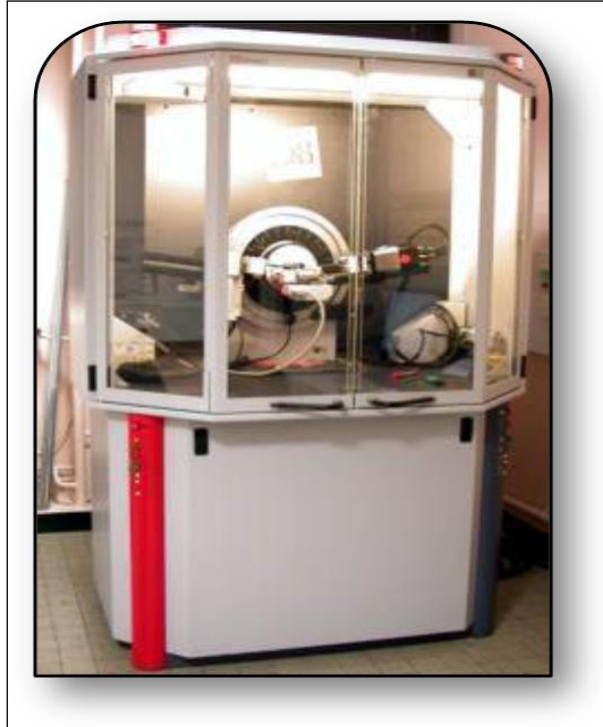
Figure II.5 : Photographie du diffractomètre Bruker D8 Advance (Unité de recherche, Université Mentouri, Constantine, Algérie).
