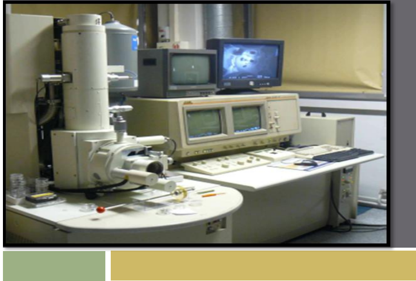
Figure II.7 : Photographie du microscope électronique à balayage (Faculté de médecine, université d'Angers, France)
